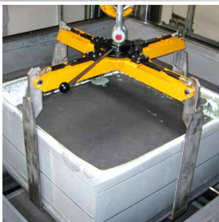
◀ 800 kg Gen6 silicon ingot
